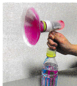
風を受けてLEDが光る「風力発電工作」
